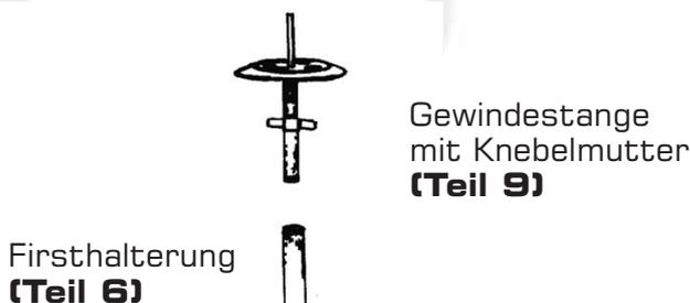
7. Führen Sie jetzt die Gewindestange in die Bohrung der Firsthalterung **(Teil 6)** ein. Setzen Sie den Teller **(Teil 7)** auf die Gewindestange. Legen Sie die Dachplane **(Teil 10)** mit dem Loch über den Teller. (glänzende Seite nach außen).
