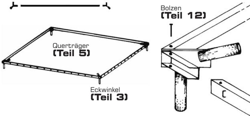
4. Stecken Sie die Dachstreben **(Teil 4)** in die Eckwinkel **(Teil 3)** um die Form der Abbildung zu erhalten.
