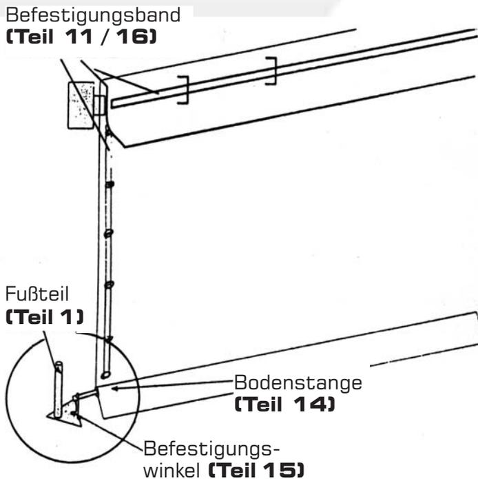
Montieren Sie nun die Befestigungswinkel an das Fußteil, indem Sie den Fuß anheben und die Schraube von unten durch die Platte durch eine der drei Bohrungen schieben, den Befestigungswinkel darüber setzen und mit der Mutter festziehen.
