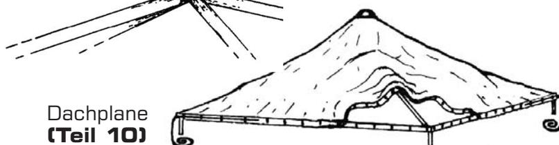
8. Ziehen Sie die Außenseite der Dachplane über die Ösenhalter der Querträger **(Teil 5)** und sichern Sie die Plane mit dem Befestigungsband **(Teil 11)**
