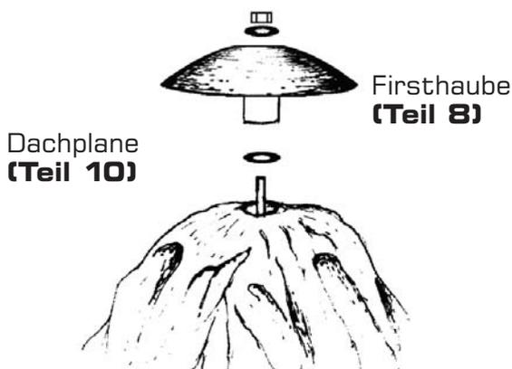
Danach wird die Firsthaube **(Teil 8)** aufgesetzt und mit Beilagscheibe und Mutter befestigt.
