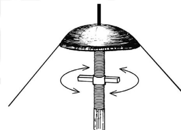
Stellen Sie nun die einzelnen Füße gerade. Bei Bodenunebenheiten können Sie das Zelt nivellieren, indem Sie die Standfüße bis zu 22 cm aus den Fußteilen heben. Danach bohren Sie mit einem Bohrer 6,5 mm oben und unten durch die vorgebohrten Standfüße und setzen die Schrauben M 6x70 (dünne Schrauben) **(Teil 13)** ein. Danach die Schrauben mit einem Hammer anklopfen und festziehen.
