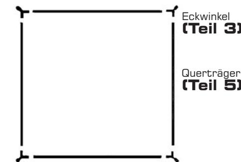
3. Stecken Sie die Eckwinkel (Teil 3) und die Querträger (Teil 5) zusammen und sichern Sie diese mit je einem Bolzen (Teil 12) links und rechts.
