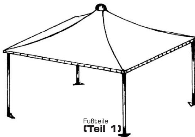
11. Schlagen Sie nun in jedes Fußteil mit einem Hammer zwei Erdnägeln schräg ein.
