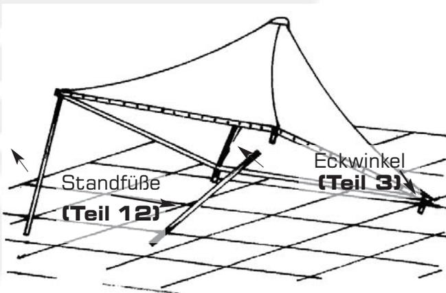
Die Spannung sollte zunächst nach vier Wochen und später 2 x pro Jahr überprüft werden, da sich die Dachplane mit der Zeit ausdehnen kann.
