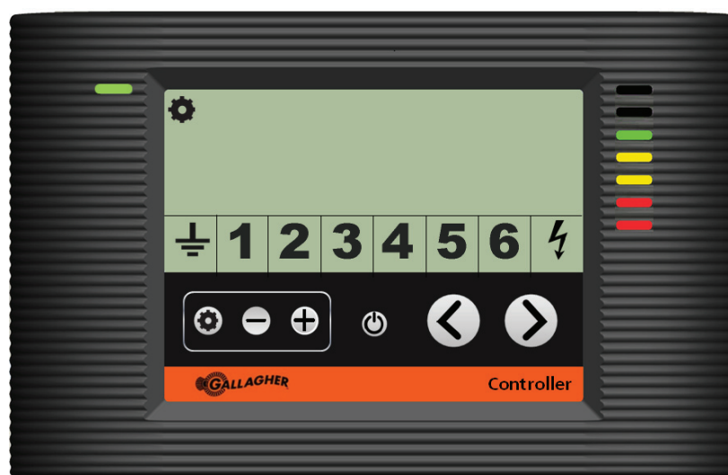
Die Steuereinheit zeigt die Ausgangsspannung, die reguliert wird
