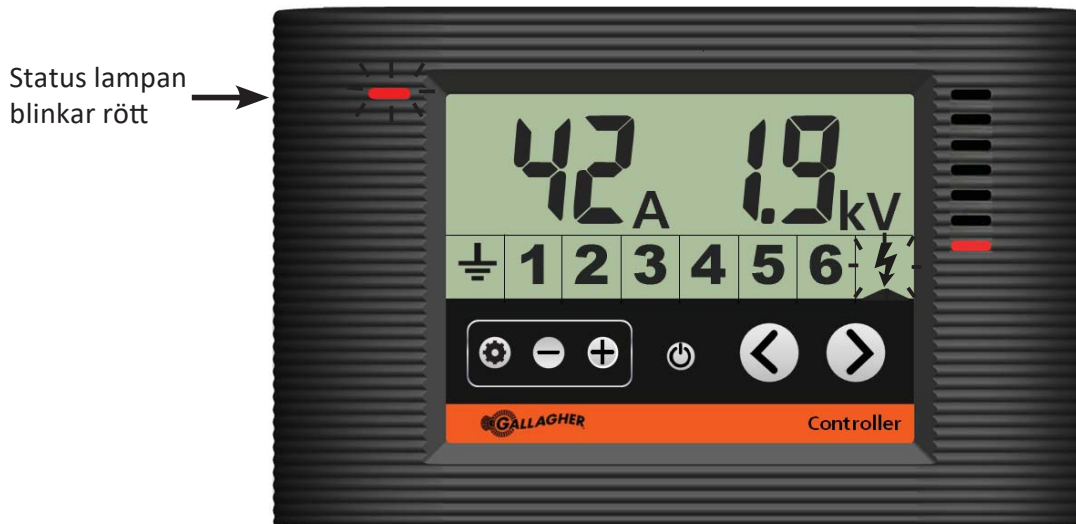
Kontrollen visar aggregat i ström larm
