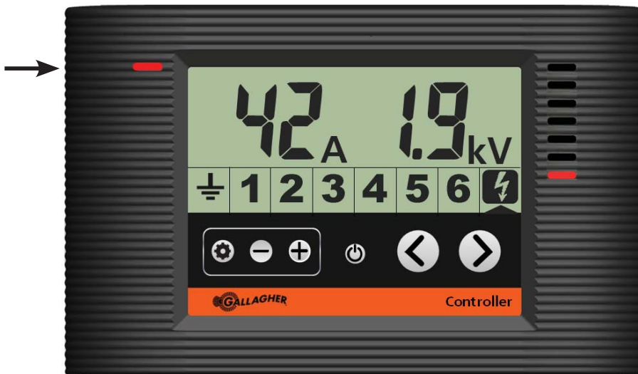
Kontrollenheten visar aggregatet i utgångslarm
