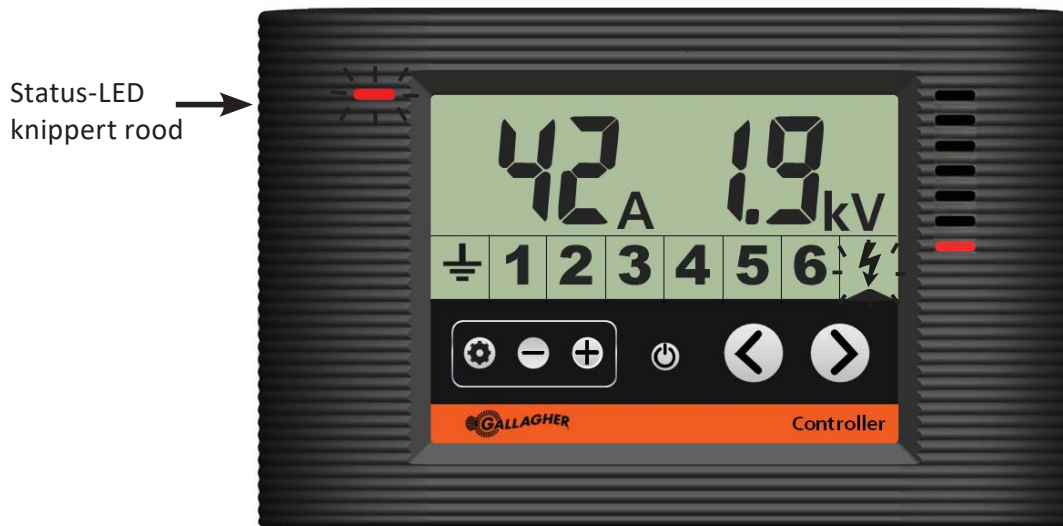
Bedieningspaneel toont het schrikdraadapparaat in stroomsterktealarm
