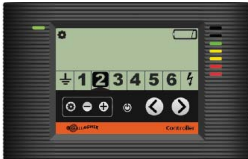
Kontroll visar zon 2 med en låg batterinivå
