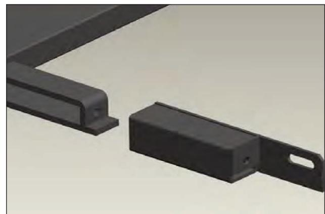
4. Vierkantrohr über den L-Winkel und die Achse schieben
