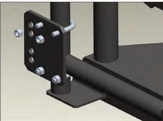
3. Obere Bügelschraube befestigen
