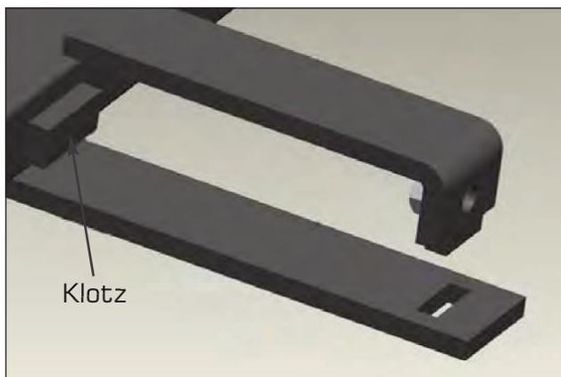
3. langes Ende des L-Winkels auf den Klotz setzen und kurzes Ende in die dafür vorgesehene Bohrung stecken
