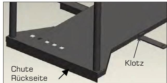
2. Im hinterem Drittel der Chute ist an den beiden Seiten des Bodenbleches ein vier-eckiger Klotz angeschweißt. An dieser Stelle die Achse unter die Chute schieben
