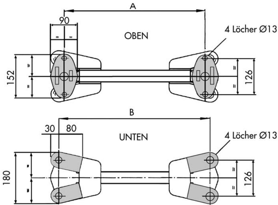
Die grauen Flächen zeigen die Lasteinleitungen für die Wiegestäbe. Stellen Sie sicher, dass die Wiegestäbe nur über die grauen Flächen belastet werden. Die Belastung sollte gleichmäßig erfolgen. Die Wiegeplattform soll auf allen vier Auflagen stehen und nicht kippen.
