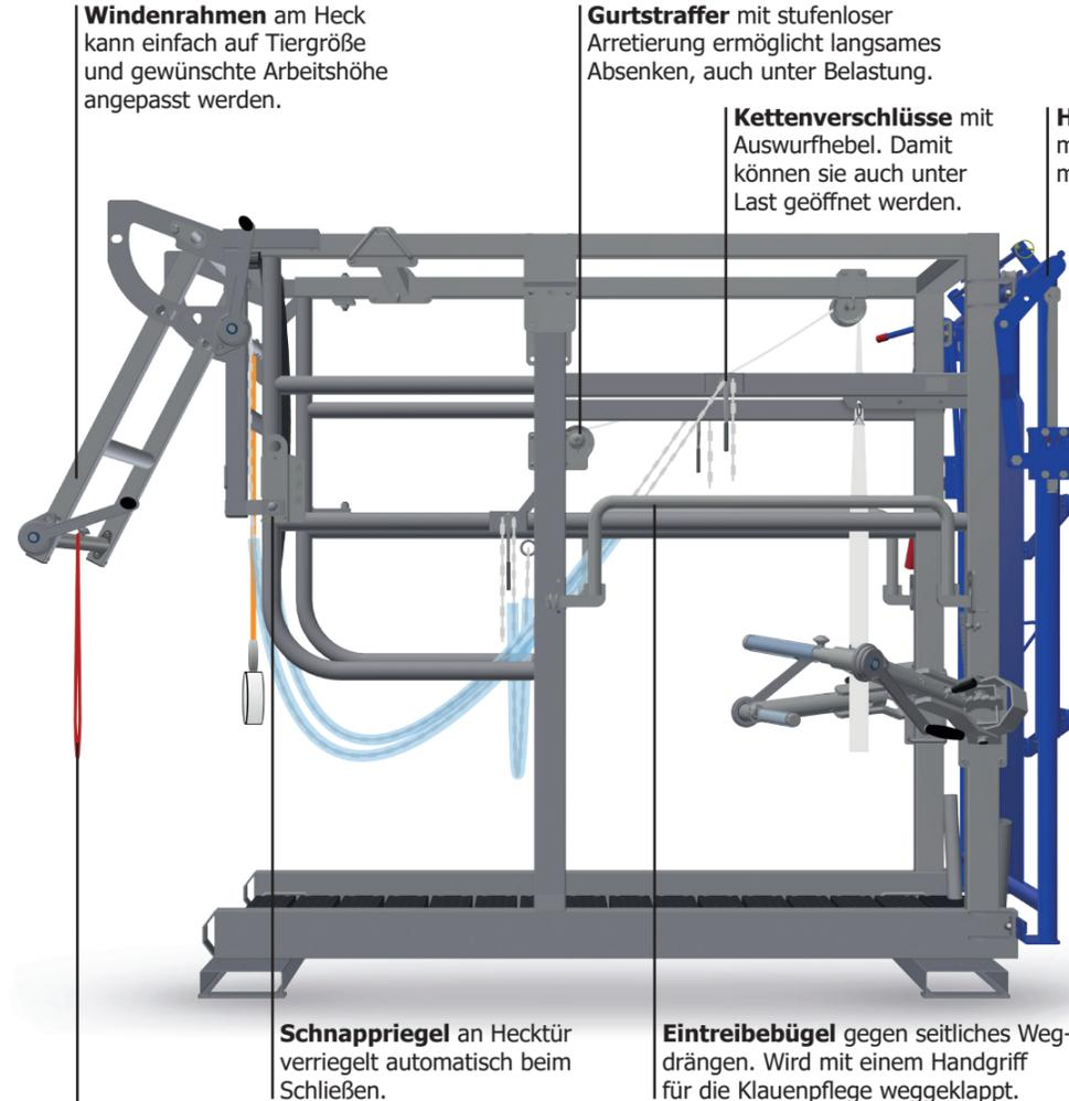
**Windenrahmen** am Heck kann einfach auf Tiergröße und gewünschte Arbeitshöhe angepasst werden.
